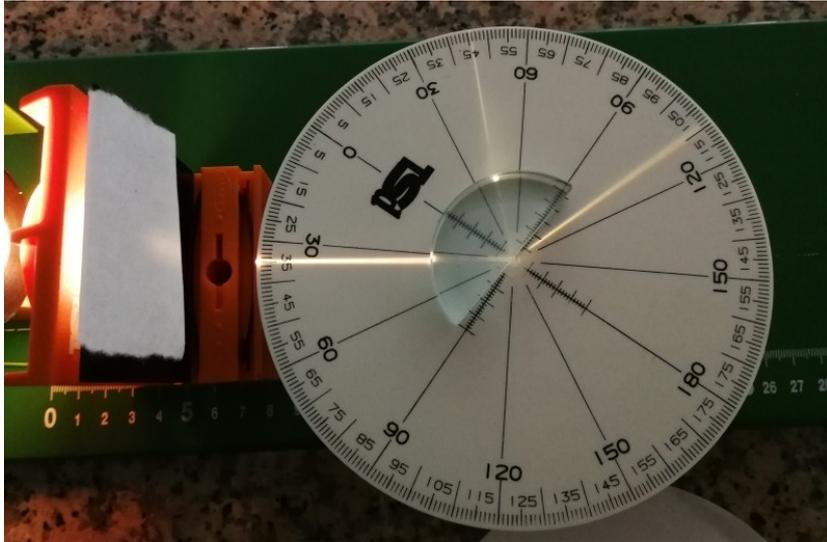
Lente con ángulo de incidencia de  $35^\circ$  y ángulo de refracción de  $71^\circ$ , aproximándose a los  $90^\circ$
