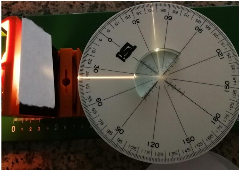
Lente con ángulo de incidencia de  $38^\circ$  y reflexión total después de que el ángulo de refracción haya superado los  $90^\circ$
